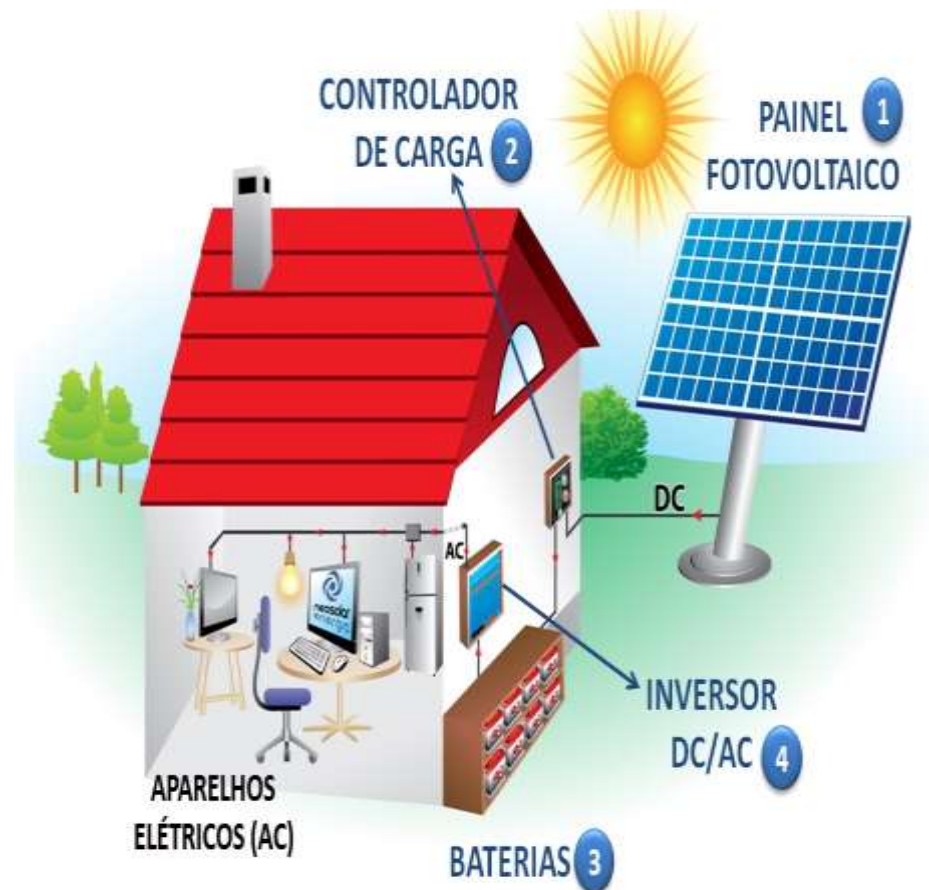
FIGURA 3 - Exemplo de um Sistema Isolado Fonte: Neosolar Energia (2016).
