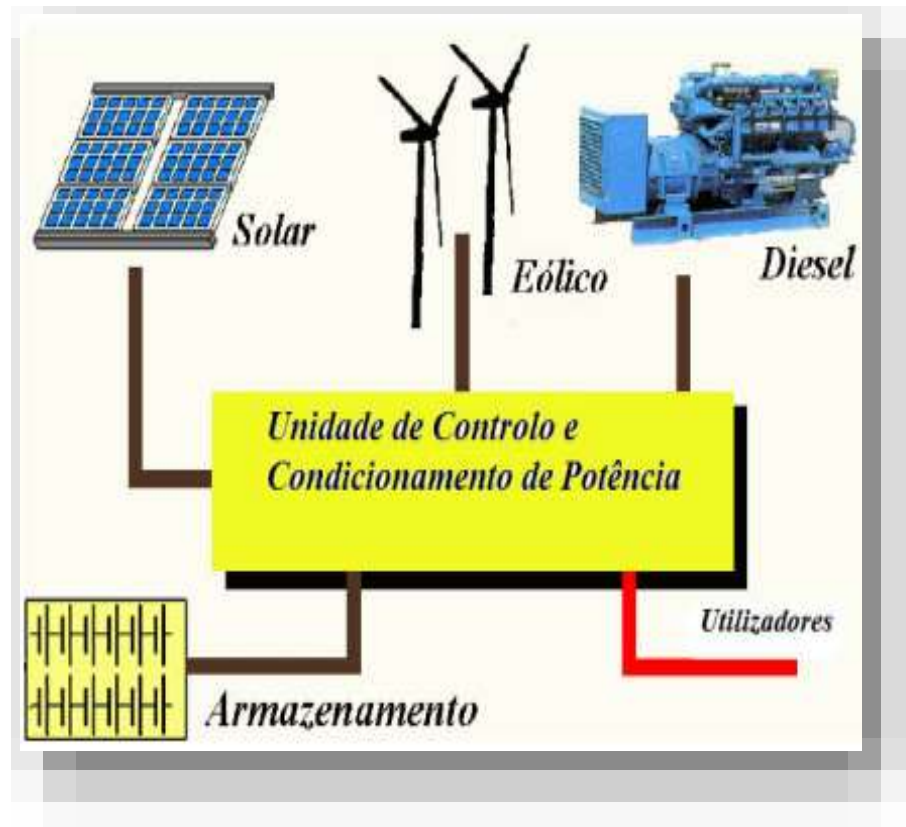
FIGURA 5 - Exemplo de Sistema Híbrido Fonte: Freitas (2008).
